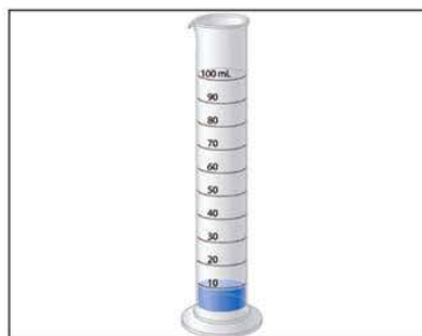
▲ Figure (8) Un cylindre gradué de 100 ml de capacité
